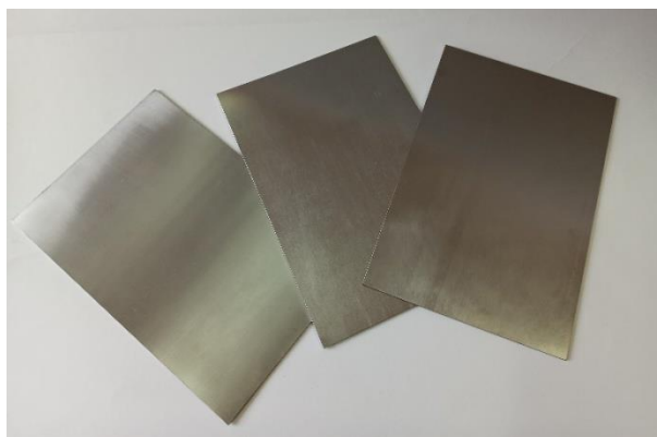
Рис. 3. Внешний вид ниобиевых листов размером 2×200×300 мм квалификационной партии
